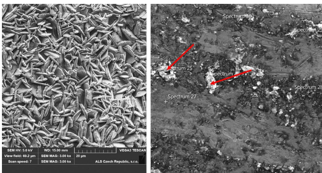
Immagine 2: (A) Strato anticorrosivo; (B) tracce di corrosione
